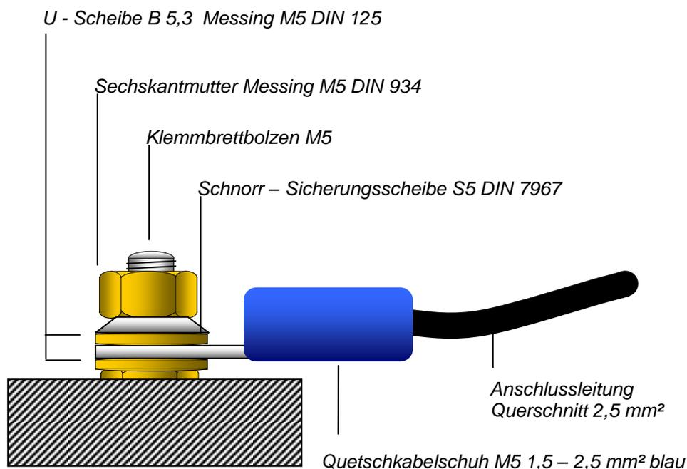
**Abbildung 8 Ausführung der elektrischen Anschlüsse im Klemmkasten**
