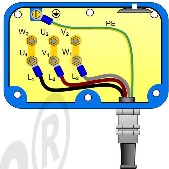
Abbildung 4 G30 Klemmkastenbelegung
