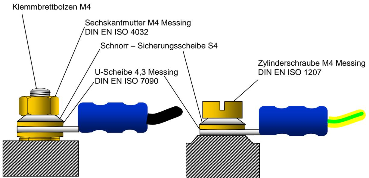
Abbildung 5 Ausführung der elektrischen Anschlüsse im Klemmkasten
