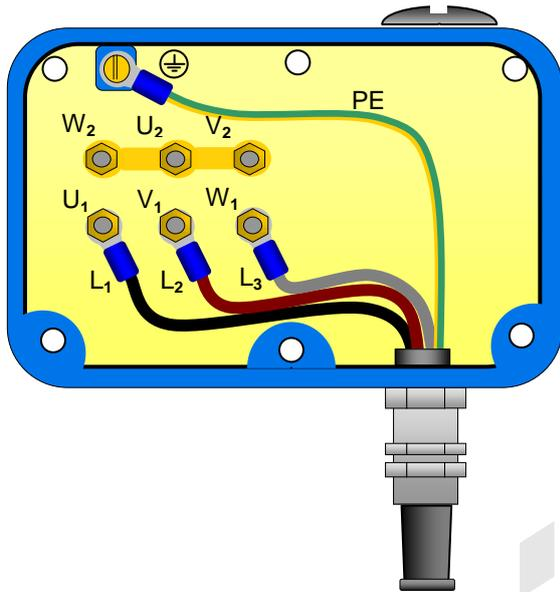
Abbildung 3 G30 Klemmkastenbelegung
